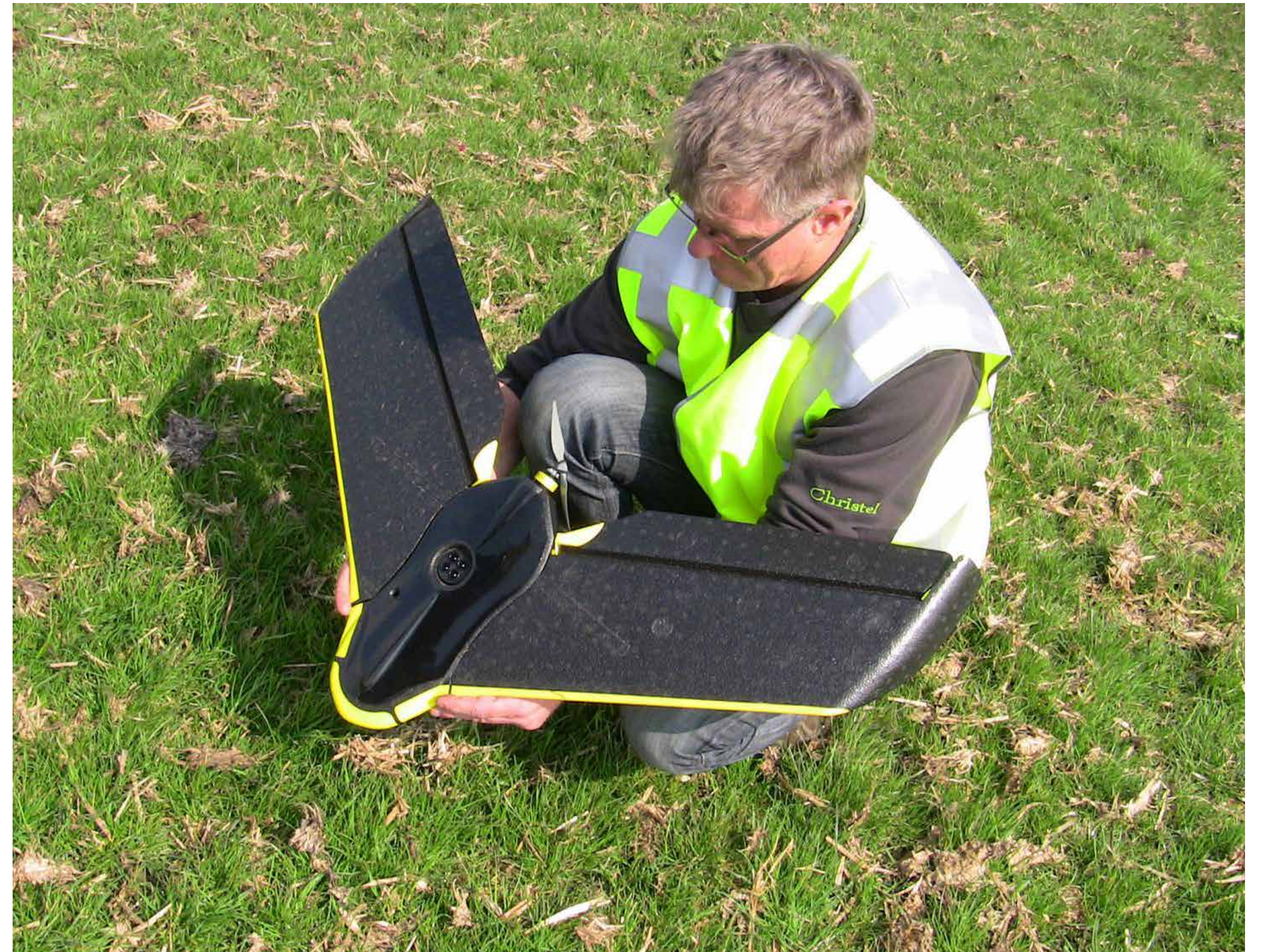
Vliegen met een drone om grasopbrengsten te meten met een multispectrale camera.
